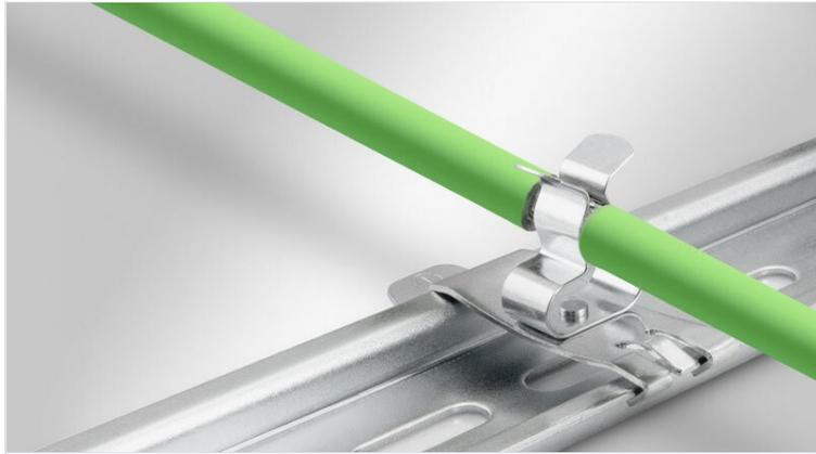
Les bornes de blindage CEM sont utilisées partout où le blindage des câbles doit être relié individuellement au potentiel de masse. Les bornes de blindage assurent un raccordement sûr et simple du blindage du câble.
